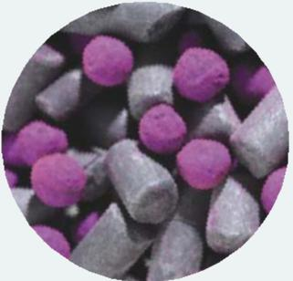
终级过滤段采用列格独有的干式滤料，含有大容量的高锰酸钾成分，增加了处理能力，不像活性炭滤料，大部分污染气体未经实际过滤。干式滤料具有更强的广谱氧化污染处理能力，尤其是现场存在多种气体的场合。
